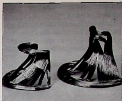
Bild 3. Horizontal-Ablenkspule für das System 20 AX (links) und das System 30 AX (rechts)
