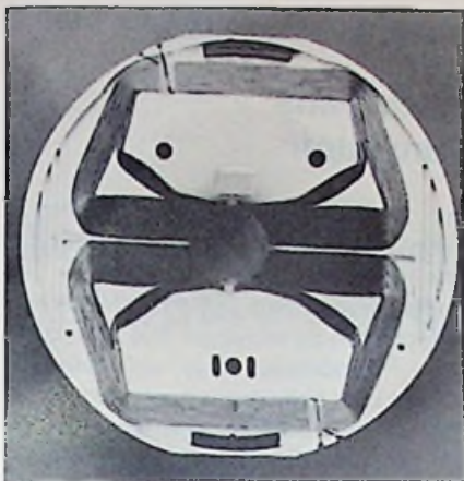
Bild 2. Die Ablenkeinheit hat eine hexagonale Ablenkspule und einen kleinen Kunststoffträger mit drei Paßauflagepunkten sowie oben und unten außerhalb der Spule je einen Dauermagneten zum Begradigen des Nord-Süd-Rasters
