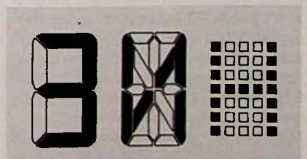
Bild 1. Anordnung der Bildpunkte bei einer 7-Segment-Anzeige (links), 16-Segment-Anzeige (Mitte) und 7 \times 5 -Matrix (rechts)
